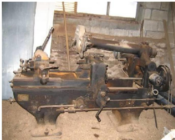
**La bûcheuse :** façonne l'extérieur du sabot à partir d'un modèle préinstallé (interchangeable).
