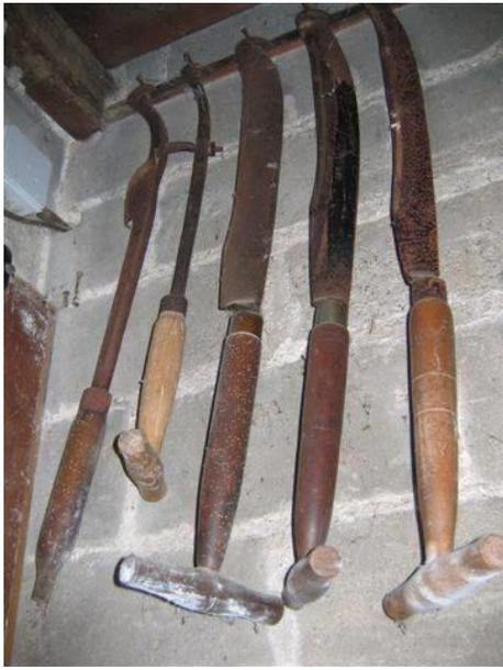
**Le paroir** : fixé au billot, le sabotier l'actionne pour supprimer les embouts de fixation sur les machines précédentes.
